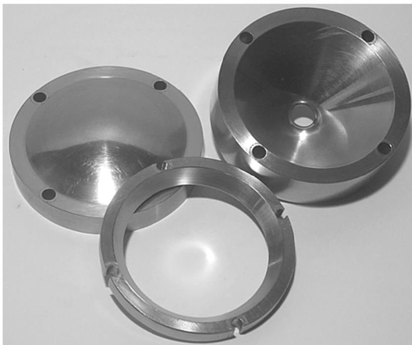
Рисунок 5.2 – Полеобразующие электроды монополярной ионной ловушки
