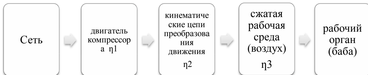
Рис. 1. Диаграмма преобразований энергии в приводном пневматическом молоте
