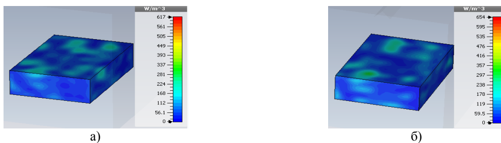
Рис. 7. Тепловыделение в рыбном блоке; а – диссектор параллелен задней стенке, б – диссектор перпендикулярен задней стенке
