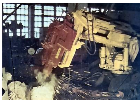
Рисунок 1 - Манипулятор большой несущей способности на инструменте (более 3 т) МГГ-1 с пятью степенями подвижности гидравлического молота для проведения и ремонта горных выработок
