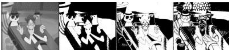
Рис. 3. Вид яркостного изображения и его составляющие 7-ой, 6-ой и 5-ой битовых плоскостей после применения сглаживающего фильтра
