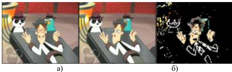
Рис.1. Смежные кадры видеосюжета (а) и результат их компенсации движения (б)
