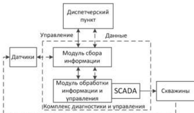
Рис. 2. Структура разрабатываемого программно-аппаратного комплекса диагностики и управления ШГНУ
