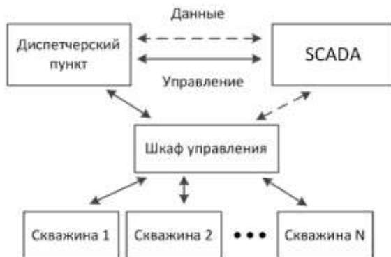
Рис. 1. Структура типового программно-технологического комплекса мониторинга и контроля ШГНУ
